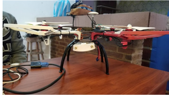
Figura 29. Drone f450 acondicionado con repetidor.
