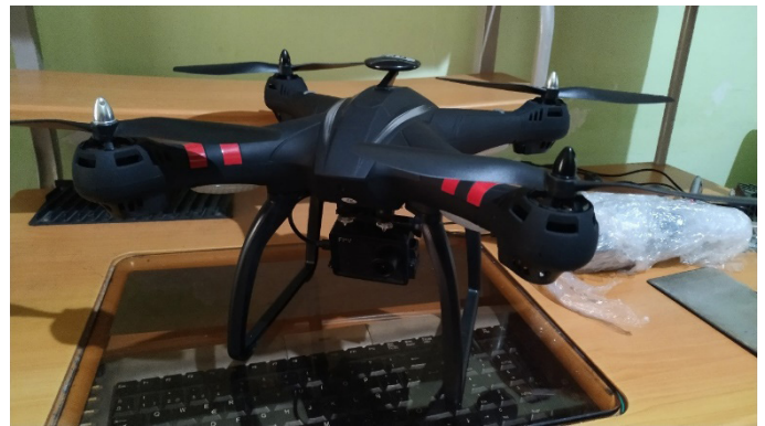
Figura 30. Drone Bayangtoys x22 acondicionado con cámara.
