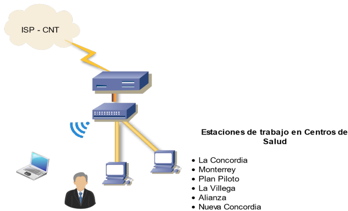
Figura 1. Modelo de conexión actual de red tipo estrella en Unidades de Salud y Distrito con proveedor CNT.
