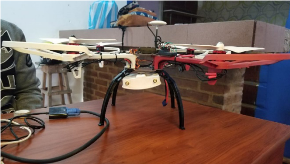
Figura 29. Drone f450 acondicionado con repetidor.
