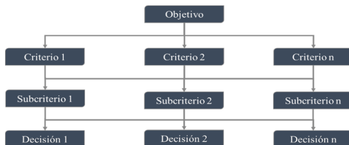
Figura 2. Esquema de un árbol genérico que representa un proceso de jerarquía analítica. Fuente adaptado de Saaty (1990)
