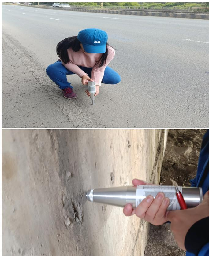
Figura 5. Esclerómetro en la losa y estribo.
