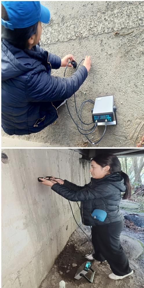
Figura 6. Ensayo de ultrasonido en losa y estribo.
